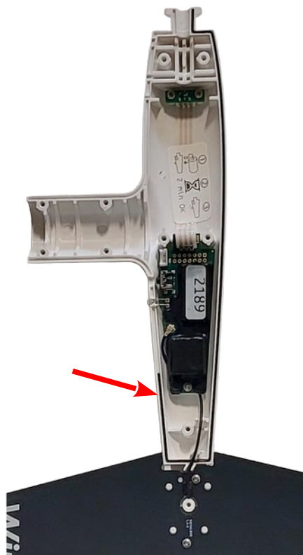
Figure 5 : Mise en place du joint de coque
