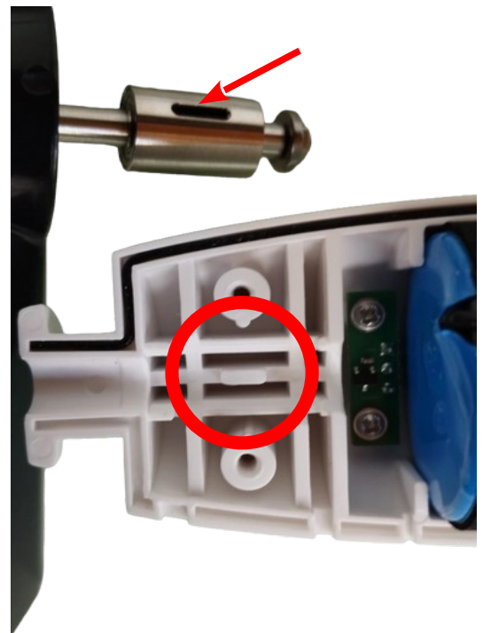
Figure 10 : Montage de l'arbre d'hélice
